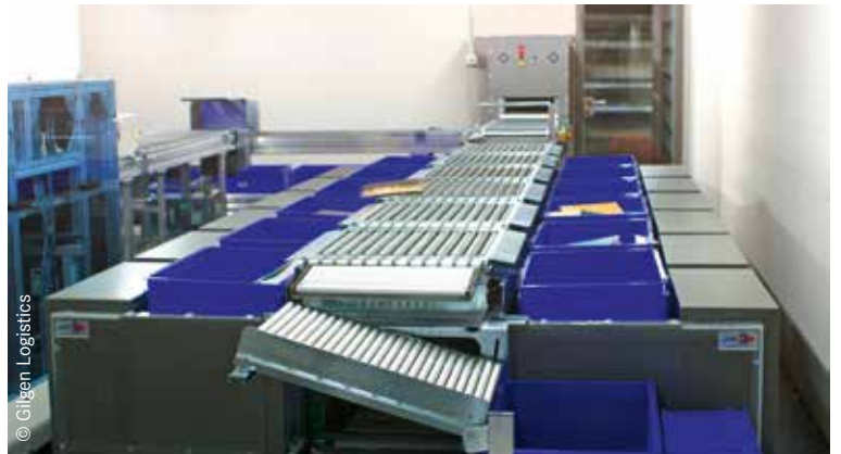
Ein automatischer Sorter teilt die Medien vollautomatisch in die zehn Zielbereiche der Bibliothek ein.
