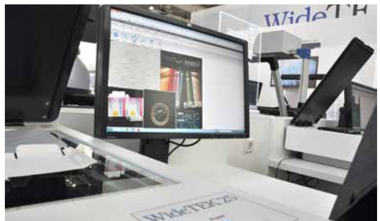
Scannt Textilgewebe mit Strukturen: Durch eine neue Lichttechnik können die WideTEK-Scanner von ImageAccess Oberflächenerhebungen auf Vorlagen sichtbar machen.
