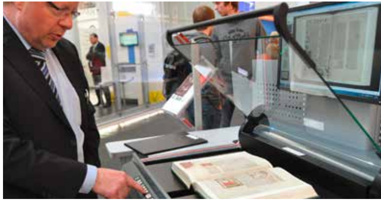
Buchauflegen, umblättern, zwei Mal Knopf drücken: Zeuschel hat den Scanvorgang mit den Geräten OS 12002 Advanced Plus, OS 12002 V und OS 15000 Advanced Plus bis auf vier Arbeitsschritte automatisiert, neue Buchschonetechnik und Sicherheitsvorkehrungen eingebaut.
