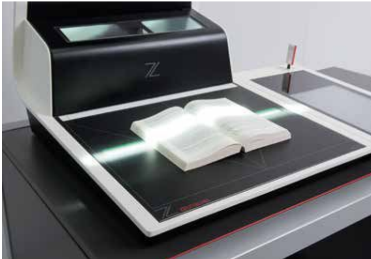
Zeilenscanner mit LED-Technologie bieten eine homogene und konservatorisch unbedenkliche Beleuchtung.
