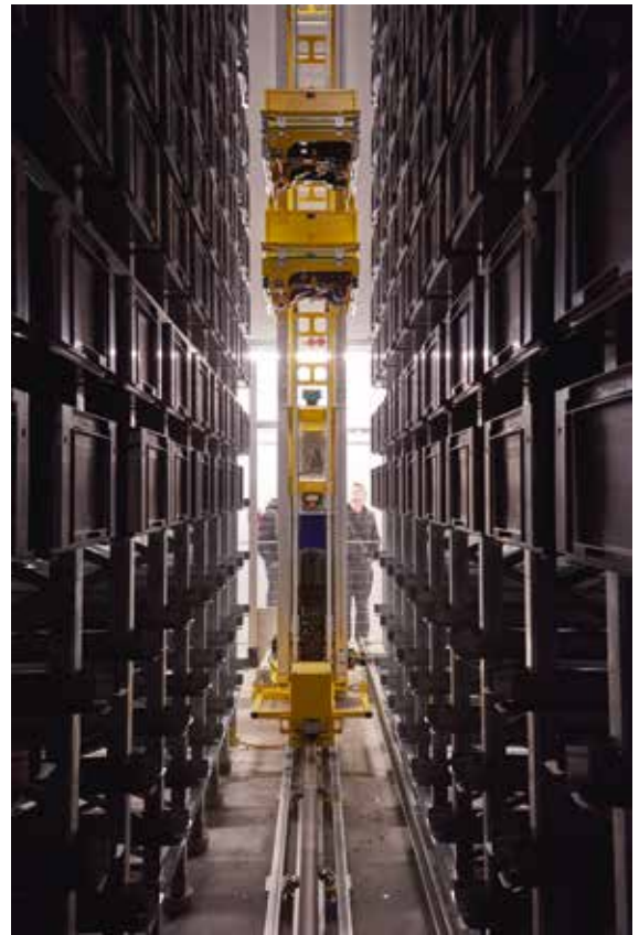
Regalbediengerät mit übereinander montierten Lastaufnahmemitteln (20.01.2010, Urheber: U. Niederer)
