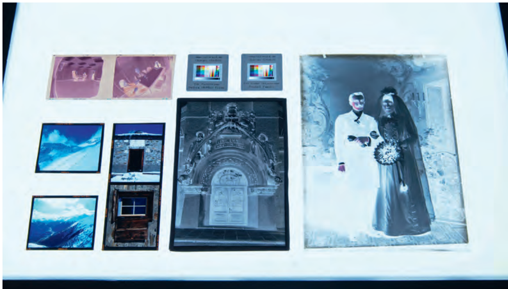
Mit dem Durchlichttisch lassen sich Filme, Dias und Glasnegative verarbeiten.
