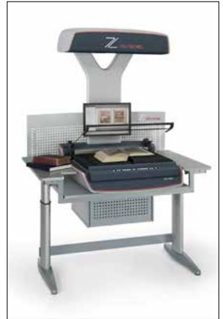
beeinflusst. Der Scanner ist schneller betriebsbereit, da bei LEDs die übliche Aufwärmphase der Beleuchtung entfällt. Der hohe Wirkungsgrad von LEDs führt zu einem niedrigeren Energieverbrauch, zudem zeichnen sich LEDs durch lange Einsatzzeiten aus.
