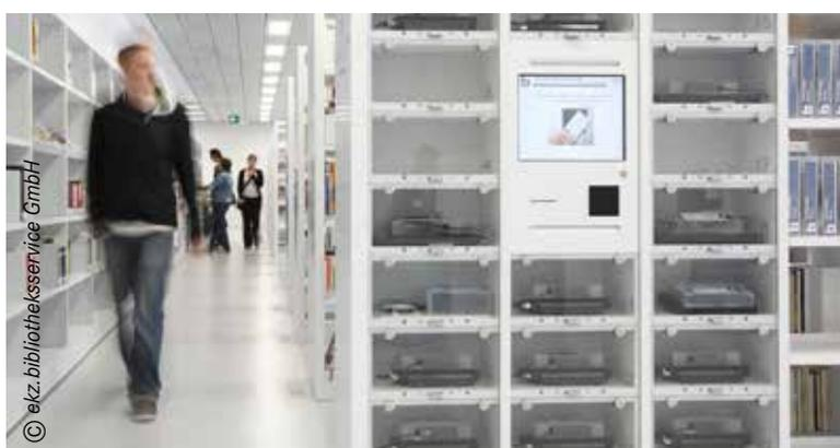
*Die EasyShelf-Solution – eine RFID-basierte Schließfachlösung zur Ausleihe von mobilen Geräten*
