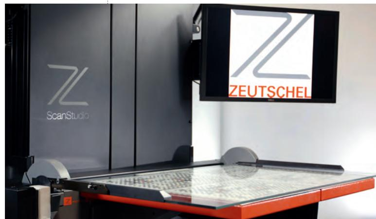
Digitalisierung aller Vorlagen bis A1-Überformat. Zu diesem Zweck ist die Buchwippe mit einer selbstöffnenden Glasplatte, verschiebbaren, selbstausgleichenden Buchauflageplatten und einer zuschaltbaren Scanautomatik ausgestattet. Für ein einfaches und ergonomisches Arbeiten sorgen die große Beinfreiheit und solide Fußschalter.
