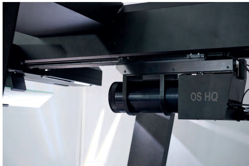
Zeutschel OS HQ_Kamerasystem.jpg: Der Zeutschel OS HQ besitzt das weltweit erste Gigapixel-Zeilenkamerasystem im Aufsichtsscanner-Markt.
